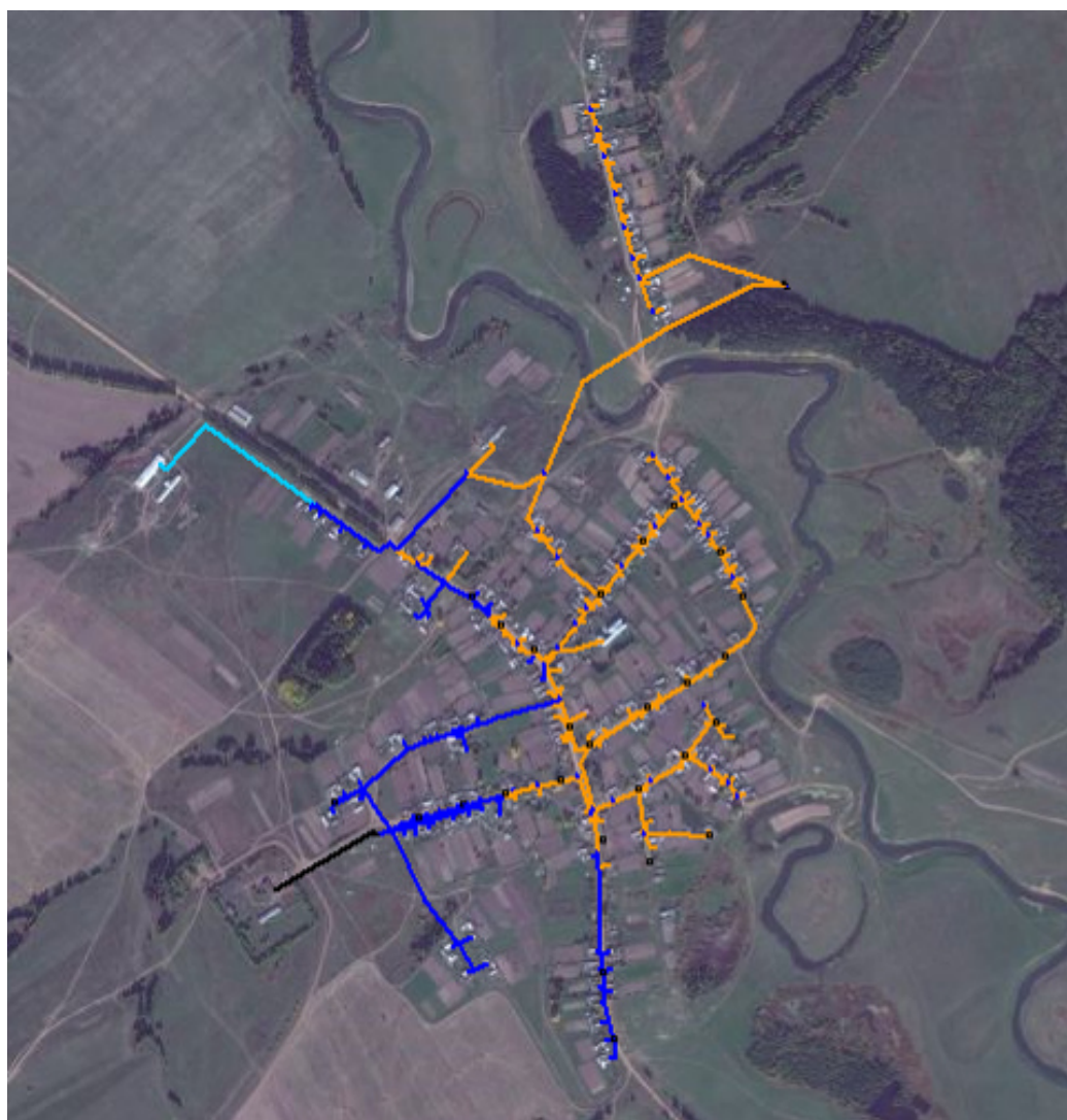
Рисунок 9 – Распределение давления в водопроводной сети д. Ворца
