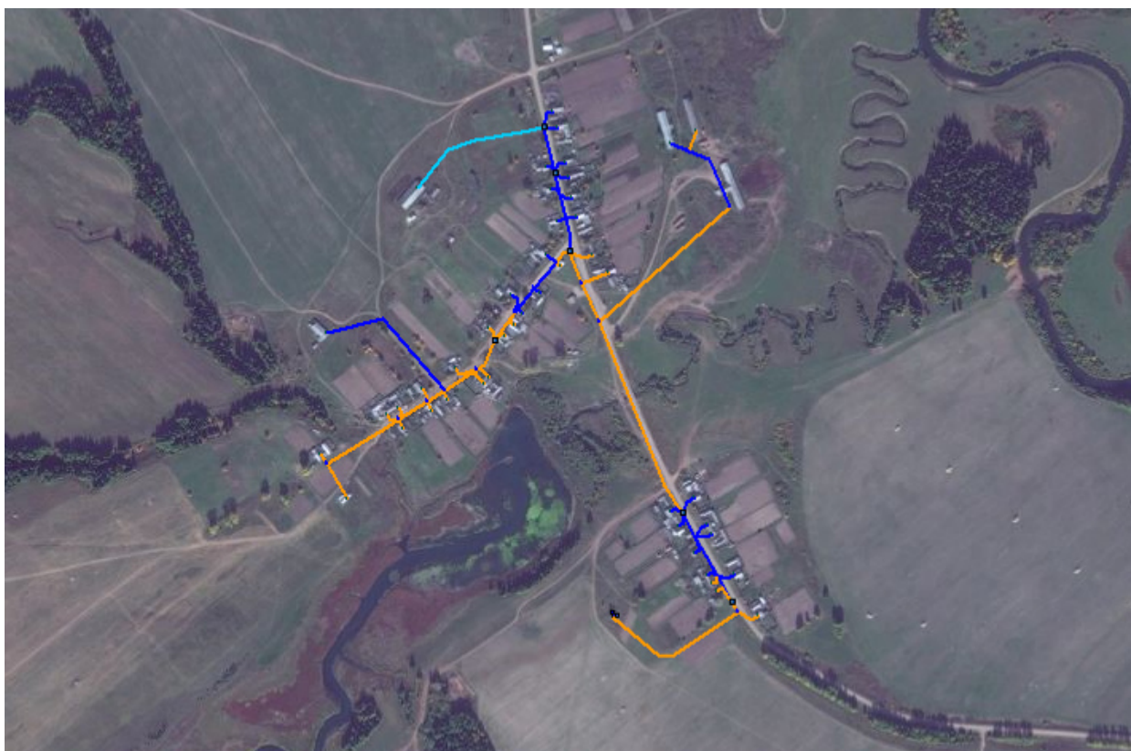
Рисунок 11 – Распределение давления в водопроводной сети д. Зянкино
