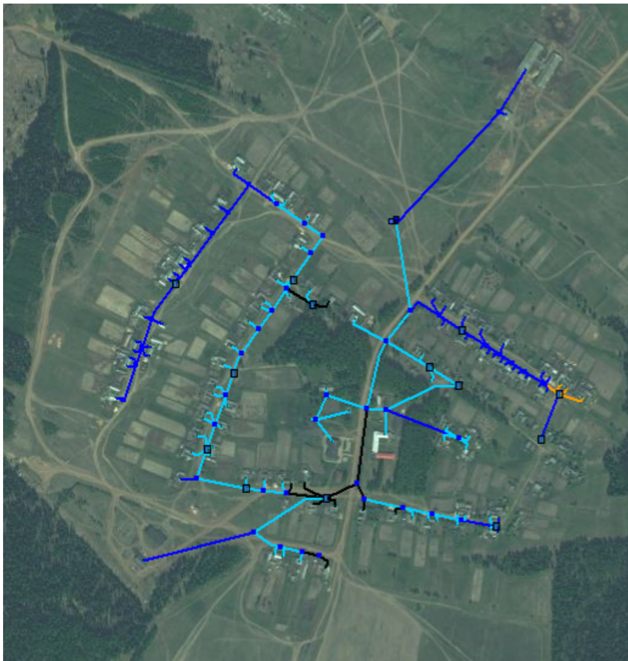
Рисунок 10 – Распределение давления в водопроводной сети с. Никольское
