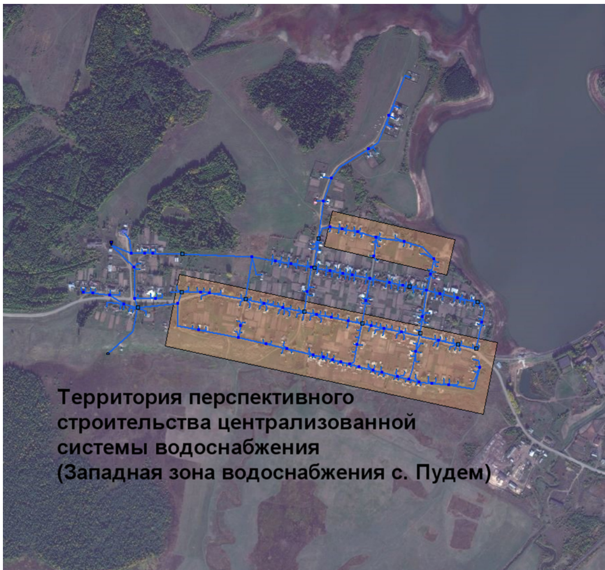
Рисунок 17 – Сети водоснабжения на территории перспективной централизованной системы водоснабжения западной части с. Пудем
