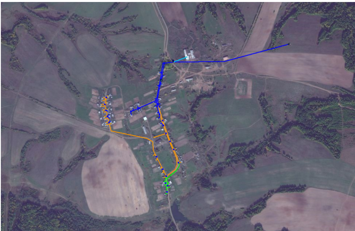
Рисунок 12 – Распределение давления в водопроводной сети д. Кузьмино
