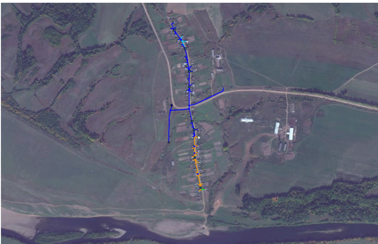
Рисунок 13 – Распределение давления в водопроводной сети д. Усть-Лекма
