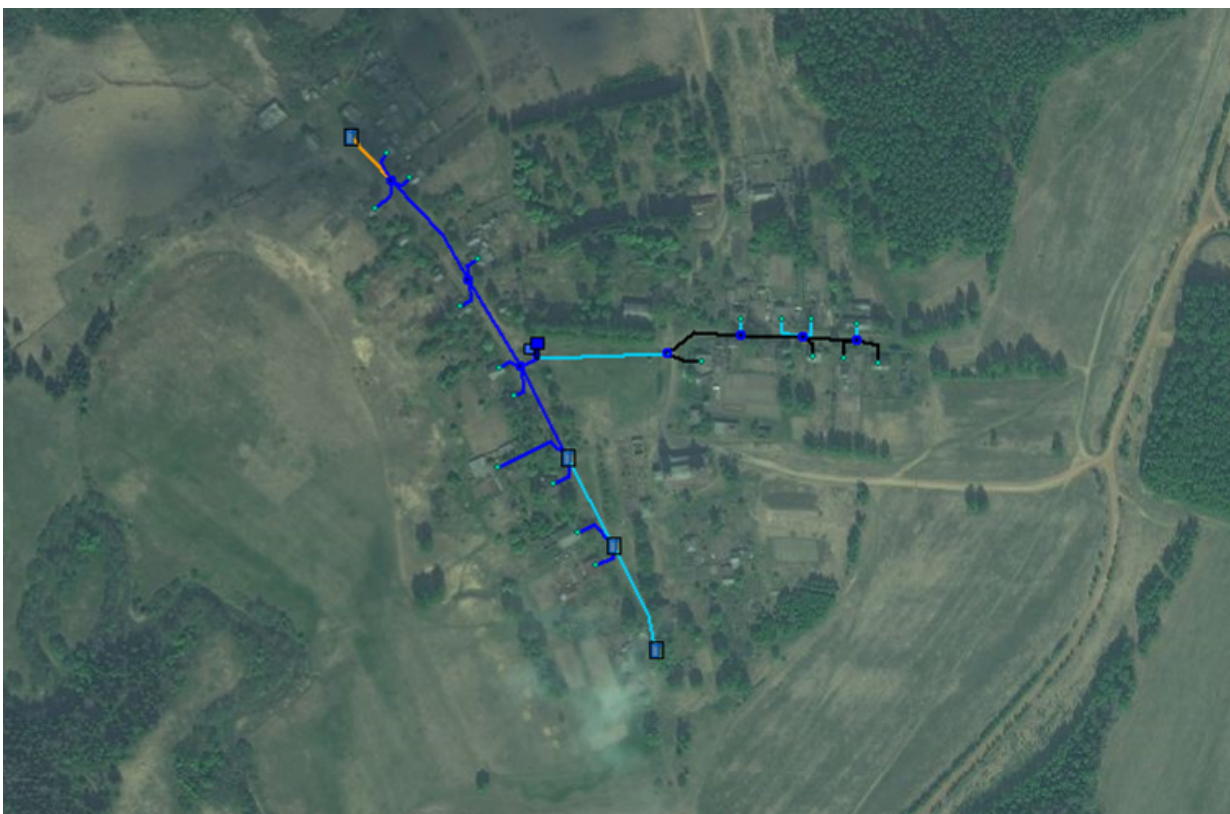
Рисунок 15 – Распределение давления в водопроводной сети с. Сада
