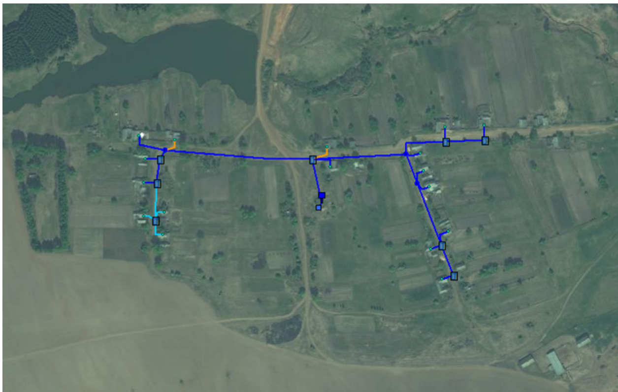
Рисунок 12 – Распределение давления в водопроводной сети д. Юдчино, южная зона водоснабжения
