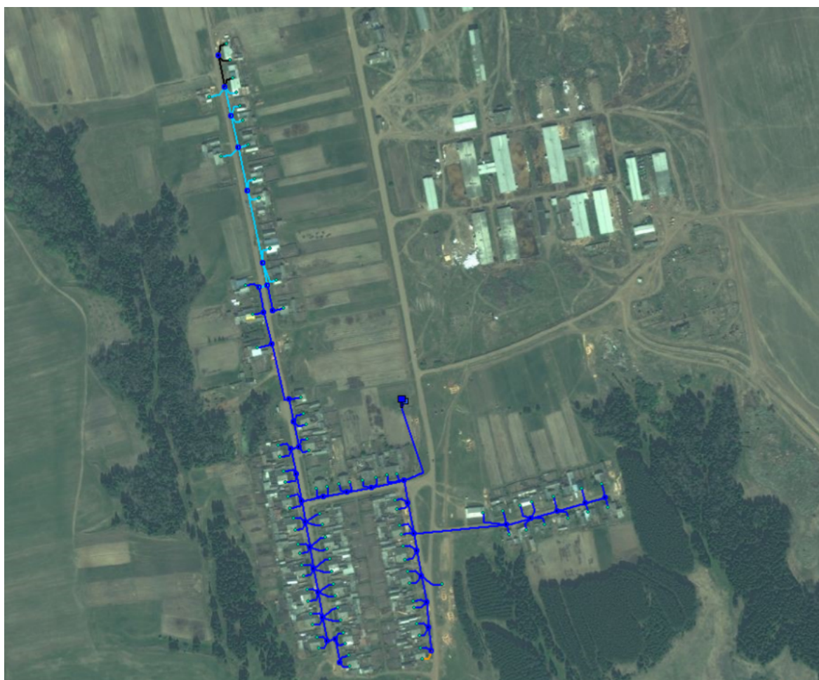
Рисунок 11 – Распределение давления в водопроводной сети д. Юдчино, северная зона во- доснабжения
